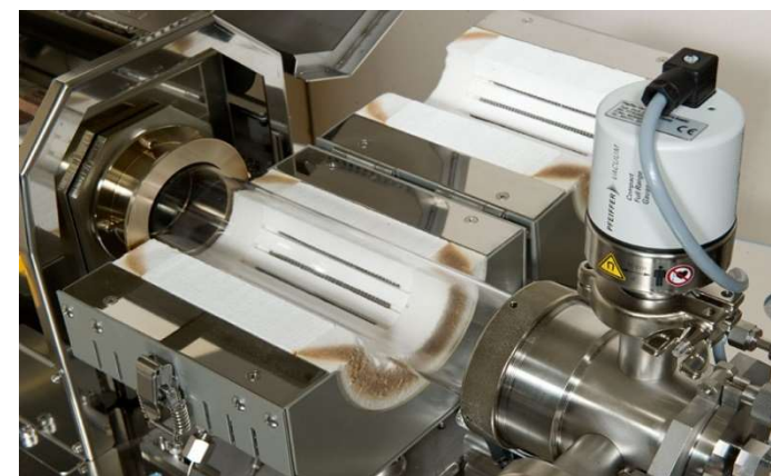
高温仕様（電気炉 + 特殊鋼管）
