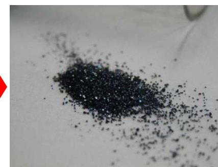
石英回収管より回収した精製材料(C60)
